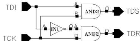
Fig. 3 Set / Reset decoder
